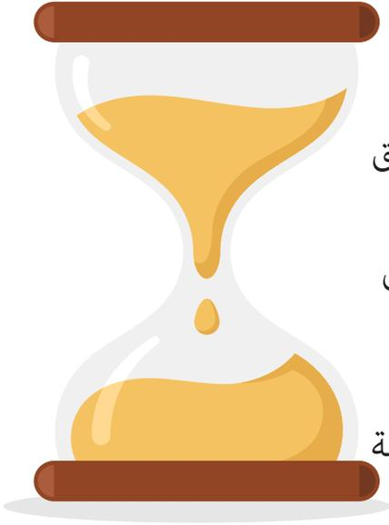
الساعة الرملية هي أداة لقياس الوقت تتكون من حُجرتين من الزجاج فوق بعضهما متصلتين بفتحة ضيقة، وتكون الحجرة العليا مليئة بالرمل الناعم الذي يتسرب إلى الحجرة السفلى ويمكن قلب الساعة عندما تمتلئ الحُجرة، ويعتبر الوقت الذي تحتاجه الخانة العلوية لتغدو فارغة مقياساً للوقت. كانت الساعة الرملية تستخدم على نطاق واسع قبل اختراع الأنواع المختلفة من الساعات،
